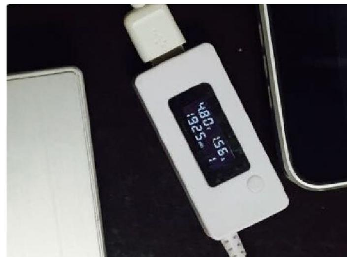
由左边的电流表可知，给IPAD充电的电流可以达到1.56A；红灯亮；电脑USB口通常能提供的电流都在1.5A左右；
