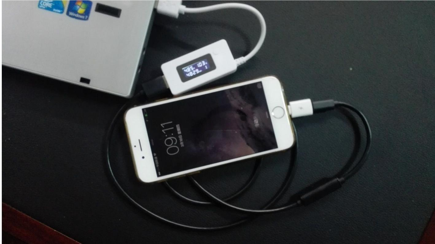
智能USB线可以在电脑休眠状态下取到电，达到原装充电器的效果；笔记本就成立一个最大的移动电源；**充电电流1.03A**；
