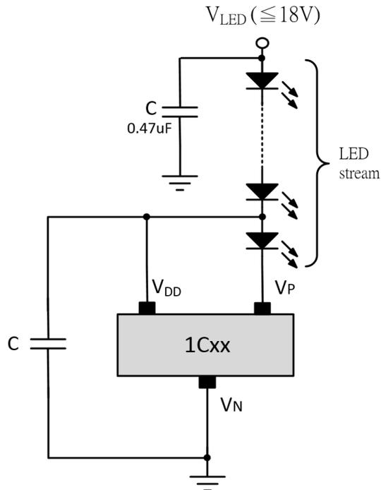
**電容:**電容值的選用大小約等於LED的工作電流。例如，若LED的工作電流為20mA，則電容值約為20nF。在實際的應用中，此電容的大小可依應用的情況斟酌調整其大小。
