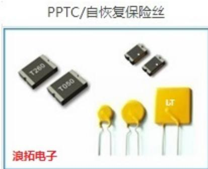
PTC是一种限流保护器件，它有一个动作温度值 $t_0$ ，当其本体内温度低于 $t_0$ 时，其阻值维持基本恒定，这时的阻值称为冷电阻。当正温度系数电阻本体那温度高于 $t_0$ 时，其阻值迅速增大，可以达到的最大阻值能过比冷电阻值打 $10^4$ 倍左右。由于它的阻值可以随温度升高而迅速增大，所以一般串联于线上用作暂态大电流的过流保护。PTC在信号线及电源线路上都有应用。
