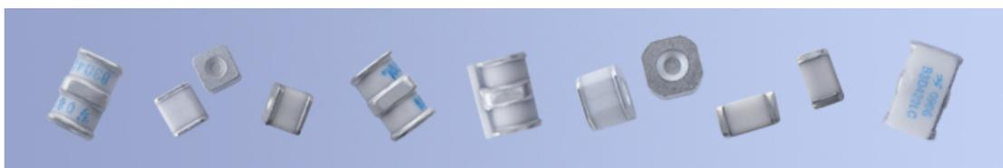
气体放电管是一种开关型保护器件，工作原理是气体放电。当两极间电压足够大时，极间间隙将放电击穿，由原来的绝缘状态转化为导电状态，类似短路。导电状态下两极间维持的电压很低，一般在20~50V，因此可以起到保护后级电路的效果。
